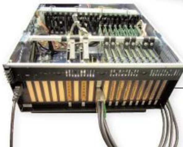
外部 16 スロット PCIe ドッキングステーション。標準 PC 用の拡張ボックスで、16 個の PCIe スロットを任意のホストシステムに導入できます
