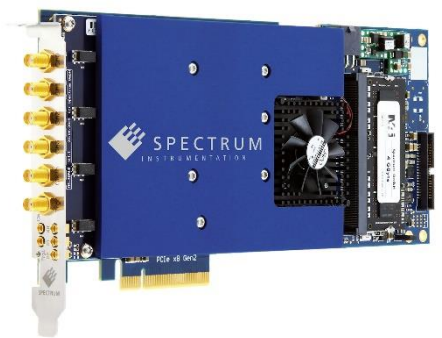
スペクトラム社の M4i.2212-x8 PCIe デジタイザ 4 チャンネル、1.25GS/s のサンプリングレート
