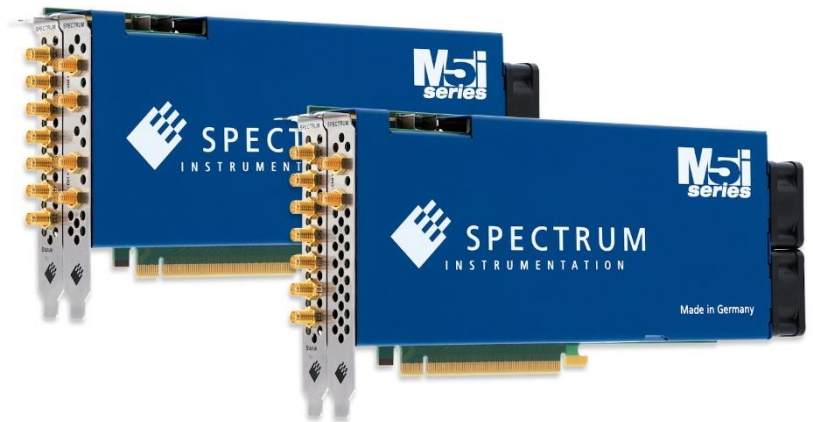
新フラッグシップの AWG シリーズは、1つまたは2つの出力チャンネルを備え、シングルエンドまたは差動で使用できます。
