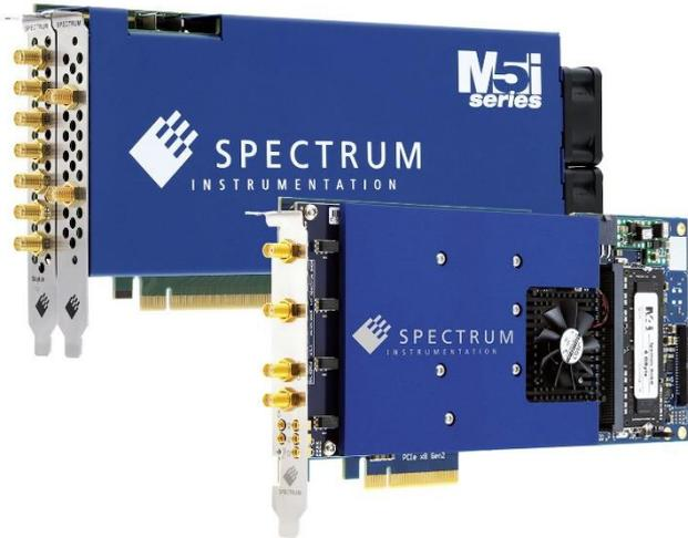
フラッグシップシリーズ、デジタイザ M5i.3357 モデルはサンプリングレート 10 GS/s、分解能 12 bit。ベストセラーの AWG M4x6631 モデルは出力レート 1.25 GS/s、分解能 16 bit
