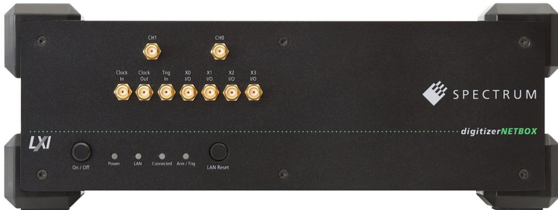
digitizerNETBOX の新たなフラッグシップ製品は最大 10 GS/s のサンプリングレートと、各種コネクタ接続を提供。
