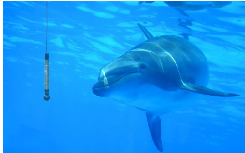
水中マイク、デジタイザ、カスタム開発された AI を組み合わせることで、イルカがソナーとして発するクリック音の焦点位置を特定
